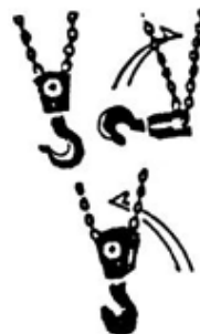
Рис. 6 Неправильное положение крюка.
